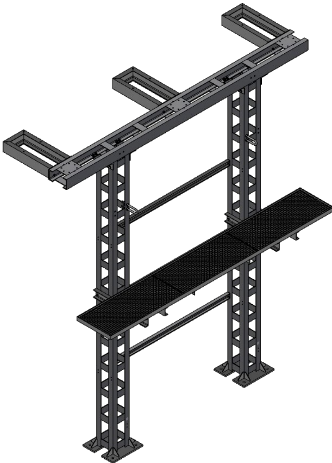
Obrázok 5 Ocel'ová konštrukcia – vyvedenie VVN a VN strany na stanovišti TR
